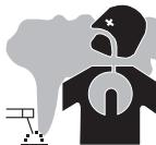
Fumi, gas e polveri emessi dalla saldatura sono pericolosi per la salute. È necessario prevedere una ventilazione sufficiente e a volte è necessario un apporto d'aria. Una maschera ad aria potrebbe essere una soluzione in caso di aerazione insufficiente. Verificare che l'aspirazione sia efficace controllandola in relazione alle norme di sicurezza.
