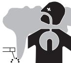
Beim Schweißen entstehen Rauchgase bzw. giftige Dämpfe. Sorgen Sie daher immer für ausreichende Frischluftzufuhr, technische Belüftung oder ein zugelassenes Atemgerät. Schweißen Sie nur in gut belüfteten Hallen, im Freien oder in geschlossenen Räumen mit ausreichend starker Absaugung, die den aktuellen Sicherheitsstandards entspricht.
