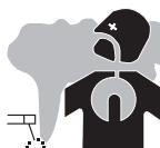
Dampen, gassen en stof uitgestoten tijdens het lassen zijn gevaarlijk voor de gezondheid. Zorg voor voldoende ventilatie, soms is toevoer van verse lucht tijdens het lassen noodzakelijk. Een lashelm met verse luchtaanvoer kan een oplossing zijn als er onvoldoende ventilatie is. Controleer of de afzuigkracht voldoende is, en verifieer of deze aan de gerelateerde veiligheidsnormen voldoet.
