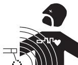
Der durch einen Leiter fließende elektrische Strom erzeugt lokale elektrische und magnetische Felder (EMF). Der Demagnetisierungsstrom erzeugt ein elektromagnetisches Feld um die Kabel und um das zu demagnetisierende Werkstück.
