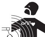
La corrente elettrica che attraversa un qualsiasi conduttore produce dei campi elettrici e magnetici (EMF) localizzati. La corrente di smagnetizzazione produce un campo elettromagnetico attorno ai cavi e al pezzo da smagnetizzazione.
