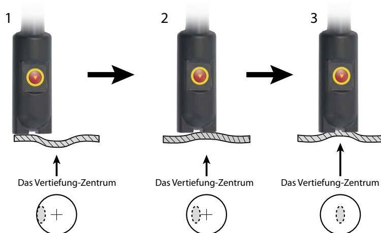
In manchen Fällen vergrößert sich die Beule während des Heizvorgangs (das Karosserieteil fällt unter der Wirkung der Hitze ein). Wenn dies geschieht, bearbeiten Sie ein größeren Bereich um die Beule herum und erhitzen Sie weiter bis die Beule kleiner wird. Bei tiefen Beulen den Bereich um die Beule herum von außen nach innen kreisförmig erhitzten.
