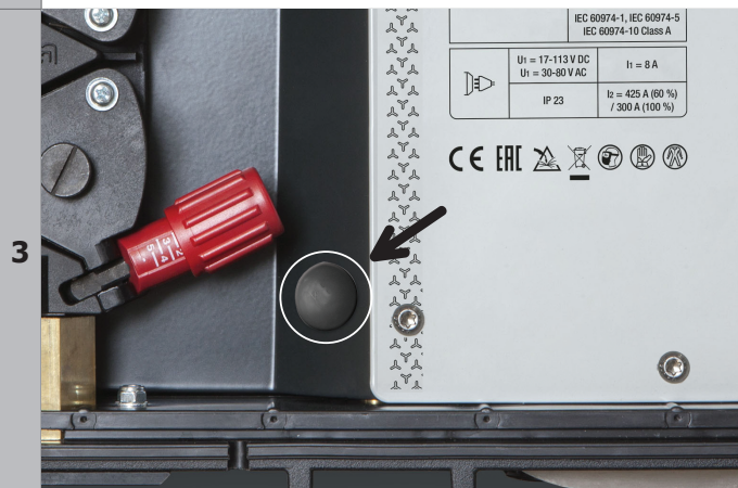
3 Retire la tapa de plástico* situada junto al carrete de la moto-devanadera.
