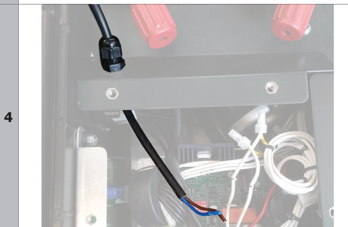
4 Pasar el cable por el agujero y bloquear el prensaestopas por medio de su tuerca.
