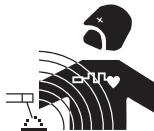
Der durch einen Leiter fließende elektrische Strom erzeugt lokale elektrische und magnetische Felder (EMF). Der Demagnetisierungsstrom erzeugt ein elektromagnetisches Feld um die Kabel und um das zu demagnetisierende Werkstück.
