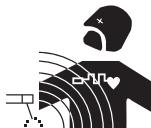
La corriente eléctrica que pasa a través de cualquier conductor produce campos eléctricos y magnéticos localizados (EMF). La corriente de desmagnetización produce un campo electromagnético alrededor de los cables y de la parte a desmagnetizar.
