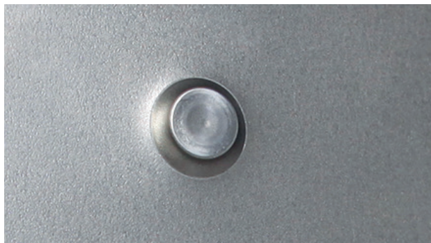
RISULTATO DELLA POSA DI UN RIVETTO AUTO-PERFORANTE
