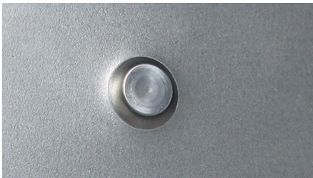
RÉSULTAT DE POSE D'UN RIVET AUTO-PERÇANT
