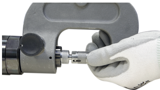
Atornillar la prolongación incluida con el brazo.
