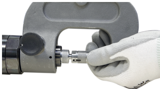
Привинтите насадку, идущую в комплекте с плечом.
