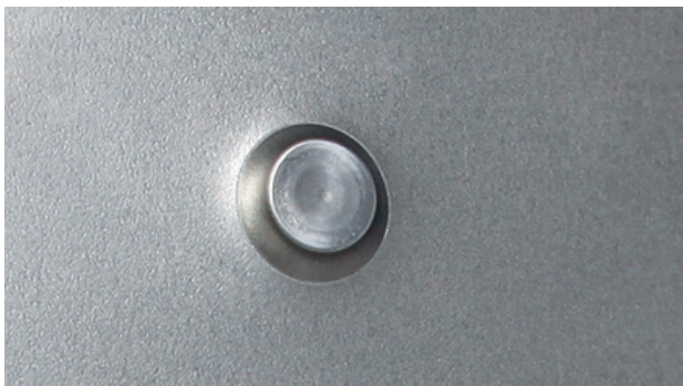
AFBEELDING PONSNAGEL VERBINDING VOOR- EN ACHTER-ZIJDE
