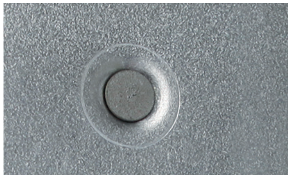
РЕЗУЛЬТАТ УСТАНОВКИ САМОПРОНИКАЮЩЕЙ ЗАКЛЕПКИ
