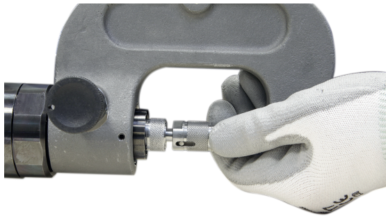
Schrauben Sie den Verlängerungsadapter an den Arm.
