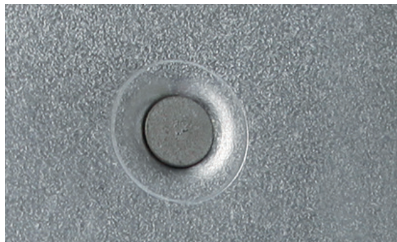
RÉSULTAT DE POSE D'UN RIVET AUTO-PERÇANT
