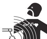
Le correnti elettriche traversano un conduttore causando campi elettrici e magnetici (EMF). I saldatori dovrebbero seguire le istruzioni sottostanti per ridurre al minimo l'esposizione ai campi elettromagnetici del circuito di saldatura:
