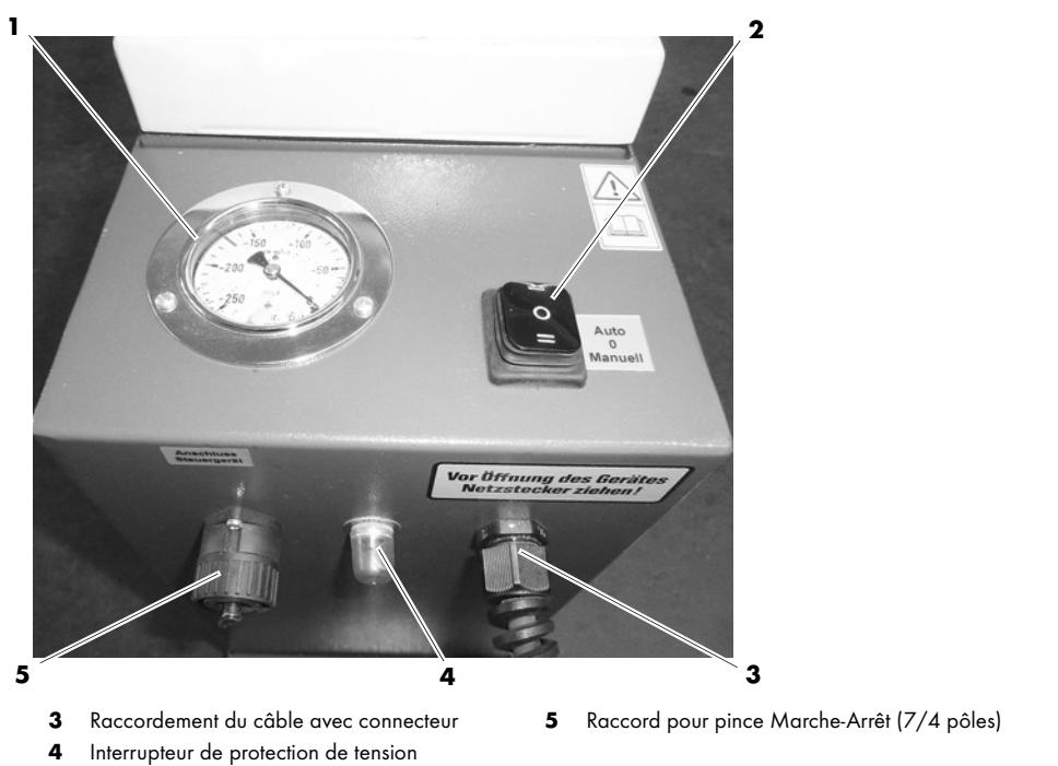
**Fig. 6** Eléments de commande
