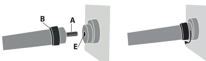
Stecken Sie den Brennkabelstecker in den Anschluss (E) und schrauben das Teil B fest. Schrauben Sie den Brenner sorgfältig fest. Um den Brenner zu entfernen, schrauben Sie wie oben genannt ab.
