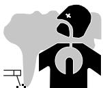
切割产生的烟雾，气体和灰尘对人体有害。预先准备好足够风力的风扇，保持空气流通。若通风不足，可使用新鲜空气面罩。
