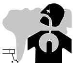
I fumi, i gas e le polveri emesse dal taglio sono pericolosi per la salute. È necessario prevedere una ventilazione sufficiente: potrebbe rendersi necessario un apporto d'aria. Una maschera ad aria fresca potrebbe essere una soluzione in caso di aerazione insufficiente. Verificare che l'aspirazione sia efficace controllandola in relazione alle norme di sicurezza.
