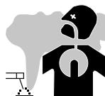
Выделяемые при резке дым, газ и пыль опасны для здоровья. Вентиляция должна быть достаточной, и может потребоваться дополнительная подача воздуха.
