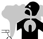
Rook, gassen en stof uitgestoten tijdens het snijden zijn gevaarlijk voor de gezondheid. Zorg voor goede en voldoende ventilatie. Soms kan verse luchtoevoer tijdens het lassen noodzakelijk zijn. Een lashelm met verse luchtaanvoer kan een oplossing zijn als er onvoldoende ventilatie is.
