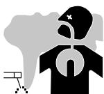
Les fumées, gaz et poussières émis par le coupage sont dangereux pour la santé. Il faut prévoir une ventilation suffisante et un apport d'air est parfois nécessaire. Un masque à air frais peut être une solution en cas d'aération insuffisante.
