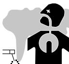
Beim Schweißen entstehen Rauchgase bzw. toxische Dämpfe. Sorgen Sie daher immer für ausreichend Frischluft, technische Belüftung oder ein zugelassenes Atemgerät.
