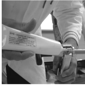
❷ Ajouter de la graisse à l'intérieur de pince et sur la tige de votre outil
