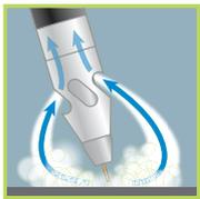
Torcia studiata per l'aspirazione e l'evacuazione dei fumi alla fonte sulla base delle torce standard MIG/MAG. Associata a un aspiratore filtrante BINZEL o collegata ad un circuito d'aspirazione centralizzato, la torcia aspirante permette di proteggere l'ambiente circostante al saldatore.
