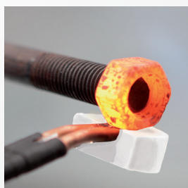
Dégrillage de boulons
