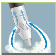
Antorcha diseñada para la extracción y evacuación de humos a la fuente, basada en las antorchas MIG/MAG estándares. Combinada con un aspirador filtrante BINZEL o conectada a un circuito de aspiración centralizado, la antorcha de aspiración protege el entorno inmediato del soldador.
